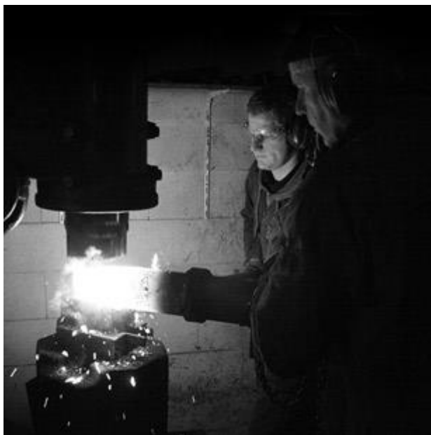
Ton Deckers in Hoogmade bij het uitsmeden en harden van een beitel.
